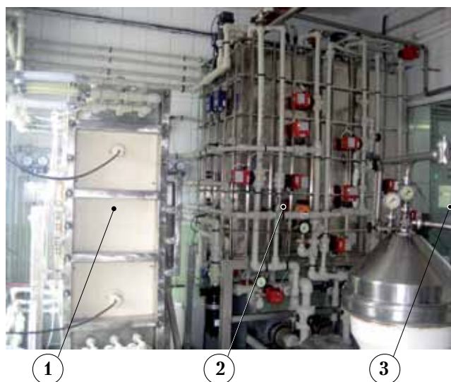
Рисунок 2. Одномодульная электродиализная установка (ЭДУ-1), предназначенная для деминерализации молочной сыворотки:
